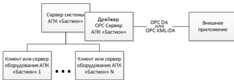
Рис. 1. Схема интеграции с использованием OPC Сервера АПК «Бастион-2»
